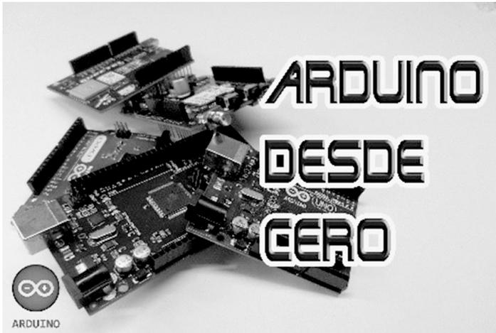
**A** rduino es una herramienta de entrenamiento electrónico de hardware libre, diseñada con el firme propósito de facilitar el aprendizaje electrónico, una simple placa de circuito impreso y un entorno de desarrollo derivado del estándar libre Processing/wiring.
