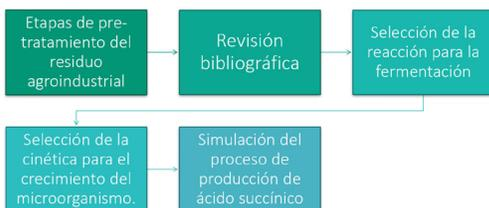
Se realizó una revisión literaria detallada en el cual se determinó cada una de las etapas del proceso de producción de ácido succínico con las condiciones necesarias que fueron simuladas en el software DWSIM.
