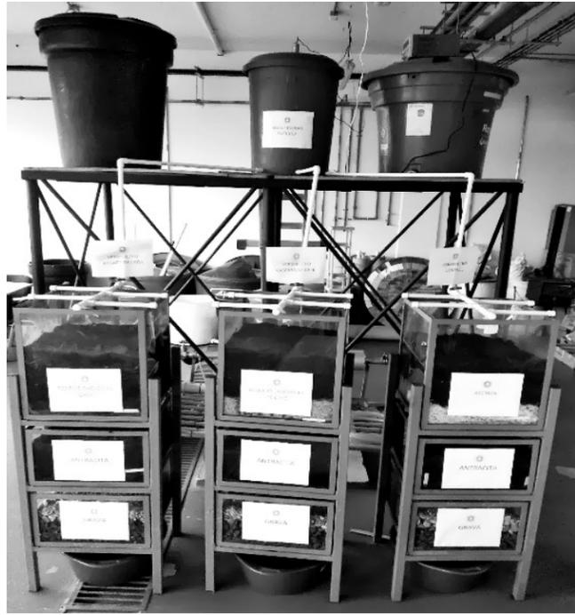
Figura 2. Sistemas de vermifiltración.
