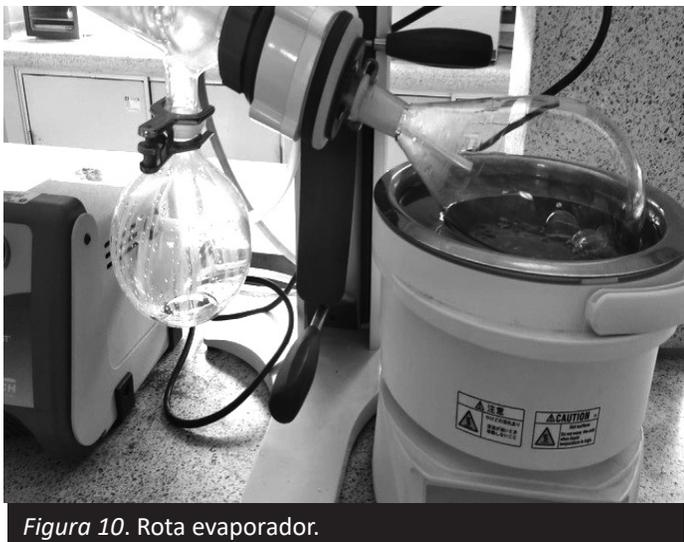
Figura 10. Rota evaporador.
