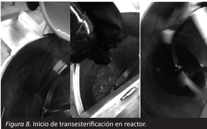
Figura 8. Inicio de transesterificación en reactor.
