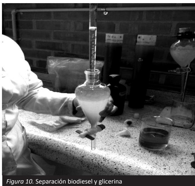
Figura 10. Separación biodiesel y glicerina
