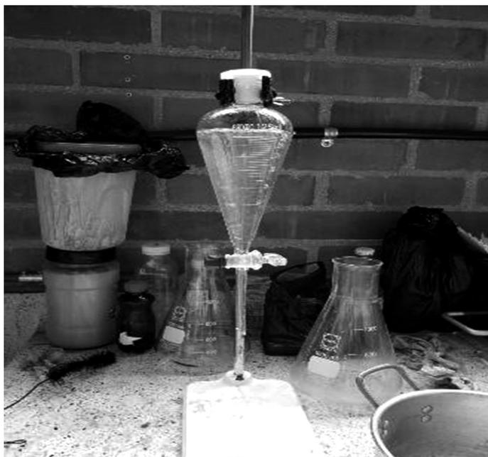
Figura 7. Embudos de decantación.
