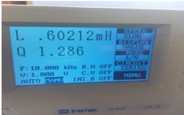
Figura 6. Medición de la inductancia de un electroimán.
