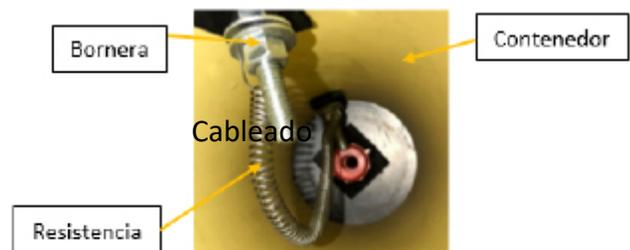
Figura 2. Módulo por resistencia eléctrica.
