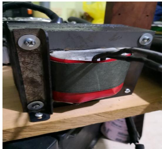
Figura 8. Transformador 110 v a 42 v, 15A.
