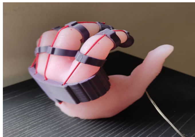
Figura 6. Prototipo de exoesqueleto en mano cerrada.
