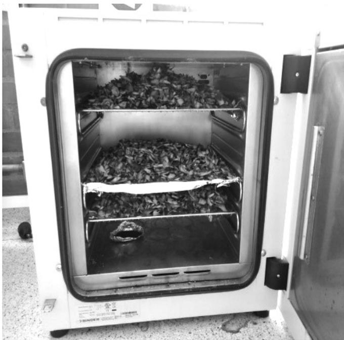
Figura 4. Secado de cáscara en el horno
