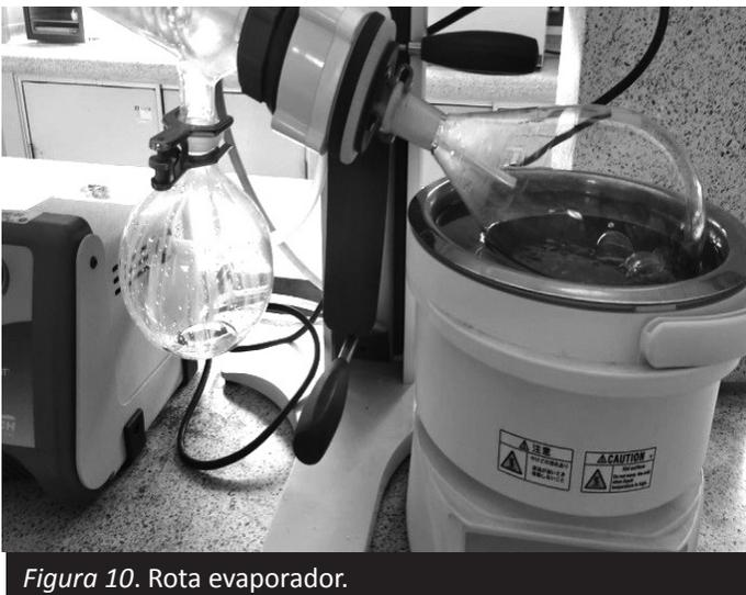
Figura 10. Rota evaporador.
